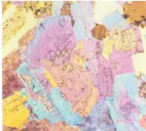
*El granito (a la izquierda) es un agregado de tres compuestos químicos distintos. A la derecha, microfotografía que pone de manifiesto la composición del granito.*
