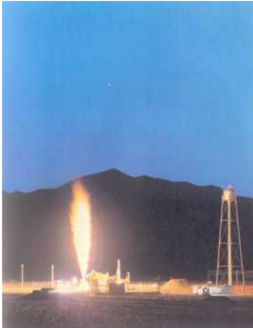
*Instalaciones exteriores del reactor experimental KIWI, usado para pruebas relacionadas con los viajes espaciales.*
